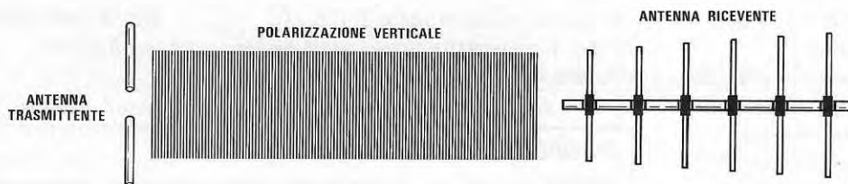
Fig.381 Se una emittente trasmette un segnale a polarizzazione VERTICALE, per captarlo, l'antenna ricevente dovrà essere installata in senso verticale rispetto al suolo.
