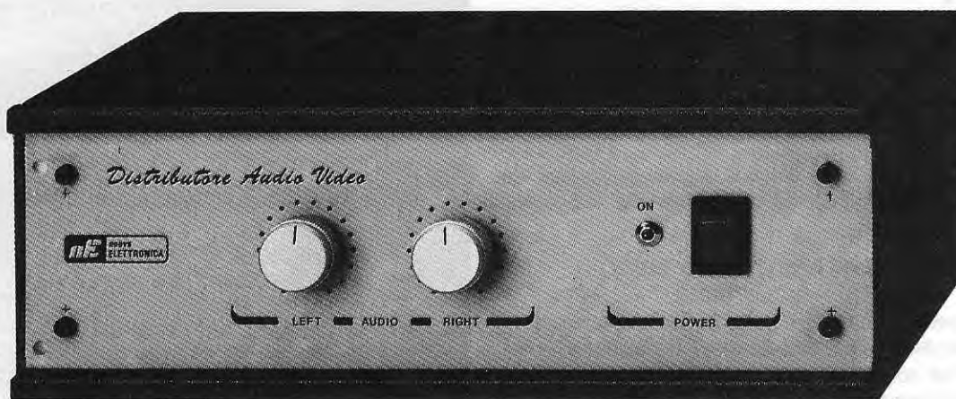
Fig.1 All'interno di questo mobile troveranno posto i due stadi Audio e Video, come visibile in fig.10. Come abbiamo spiegato nell'articolo, questo circuito vi permetterà di prelevare il segnale dalla presa videocomposita o Scart di un Videoregistratore o di una TV, per poi trasferirlo verso tre o quattro monitor, o videoregistratori, per fare delle duplicazioni di cassetta.
